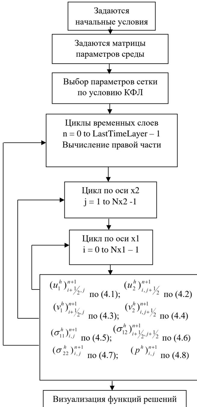
Рисунок 10 – Блок–схема численного решения сеточных функций
