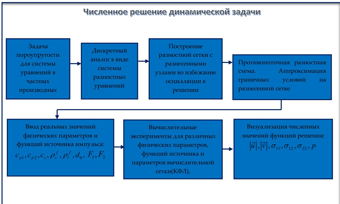
Рисунок 8 – Блок–схема численного решения динамической задачи пороупругости
