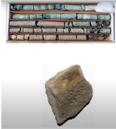
Рисунок 1 – Фото образца пористой породы, содержащей пластовые флюиды (нефть, вода и т.п.)
